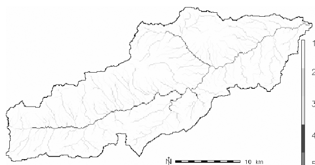
Figura 2. Red fluvial extraída automáticamente y clasificación de Strahler para la Cca. Corneros
