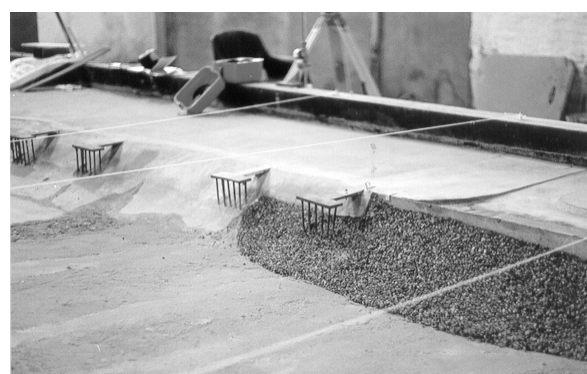
Figura 5. Ensayo con protección (Coraza)
