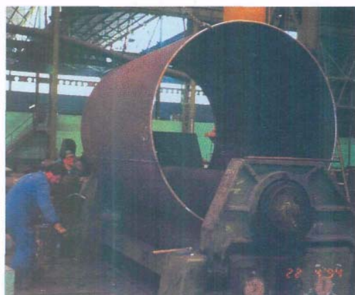
Figura 11. Fabricación del tubo de acero.
