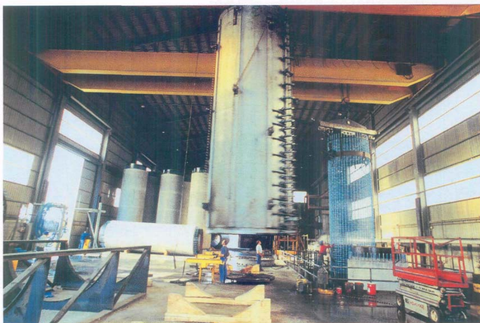
Figura 15. Vista general de la nave de fabricación del forro de hormigón armado.
