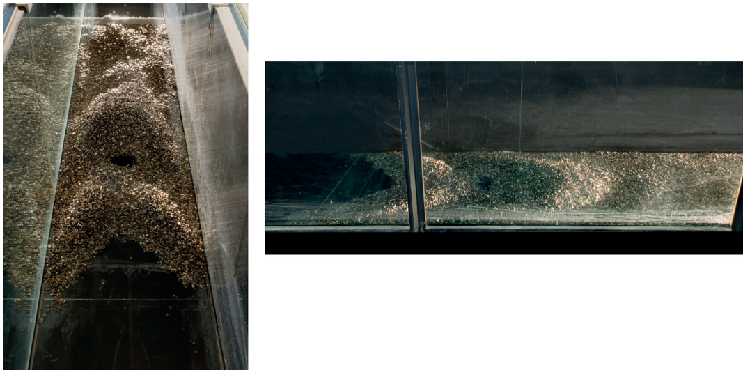
Figura 6 | Formas del lecho en canal con fondo móvil sometido a resalto hidráulico ondulatorio (VAW, ETH Zurich).
