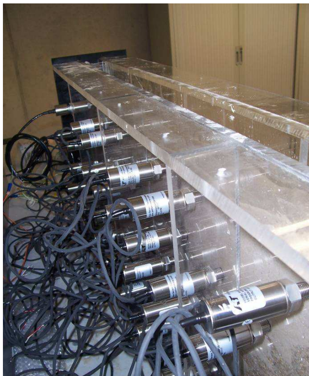
Figura 2. Detalle de la colocación de transductores de presión en la pared trasera del tanque (prototipo de la Universidad Politécnica de Valencia)
