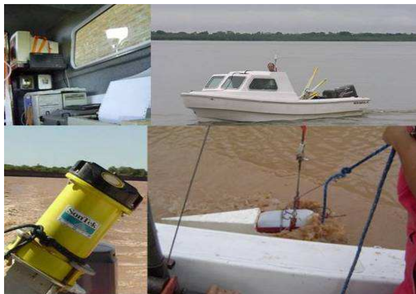
Figura 2. Equipamiento utilizado. Sonda ecoica, embarcación, ADP y captador de sedimentos en suspensión
