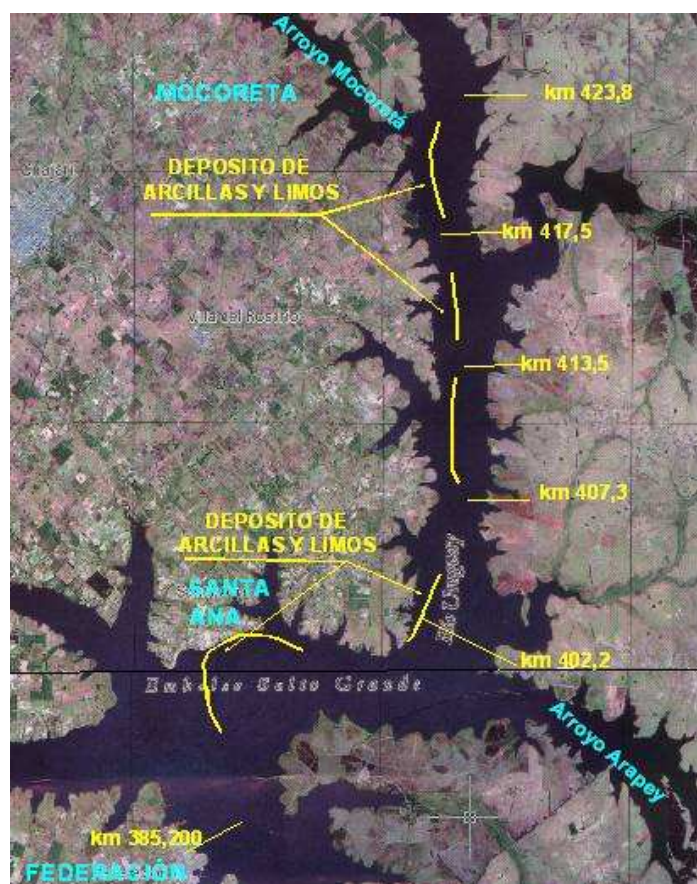
Figura 3. Zona de depósitos de finos
