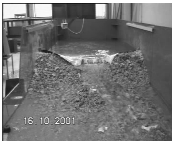
Figura 2. Modelação física da ruptura de barragens em enrocamento (Franca 2002))
