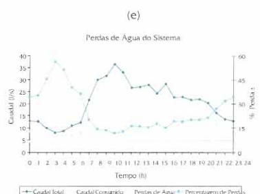
Figura 16. Desempenho do sistema de distribuição em termos de: (a) pressões, (b) flutuações de pressão, (c) e (d) velocidades e (e) perdas de água (Caso 5).
