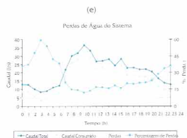
Figura 20. Desempenho do sistema de distribuição em termos de: (a) pressões, (b) flutuações de pressão, (c) e (d) velocidades e (e) perdas de água (Caso 7).
