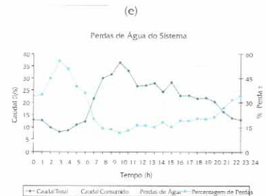
Figura 18. Desempenho do sistema de distribuição em termos de: (a) pressões, (b) flutuações de pressão, (c) e (d) velocidades e (e) perdas de água (Caso 6).
