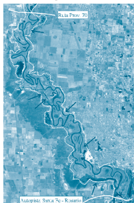
Figura 7. Progreso de los fenómenos de avulsión del río Salado hacia el año 2000; las líneas de puntos blancos marcan los bordes de la planicie anegada por las crecidas ordinarias del río, y las flechas indican la ubicación de los nuevos canales fluviales (advértase, además, el cegamiento de la embocadura del tramo de cauce del km 45, anticipada en el mapa de figura 3). (Base: imagen Landsat 7, banda 8, de diciembre de 2000; Q_{RP70} : 94 m 3 /s).
