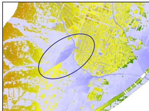
Figura 10 Barranco del Señor. Cruce ferrocarril Valencia – Villanueva de Castellón. Calados T = 100 años.
