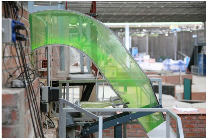
Figura 6 Flujo en el sifón casi totalmente cebado
