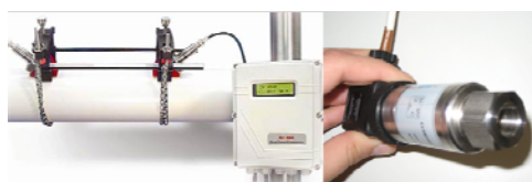
Figura 3. Caudalímetro de ultrasonidos (izquierda) y sensor de presión (derecha)
