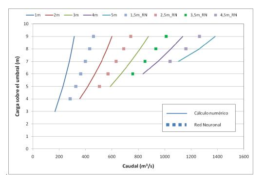
Figura 5 Comparación de los resultados de la red neuronal con aperturas intermedias con los obtenidos mediante cálculo numérico con aperturas cada metro.
