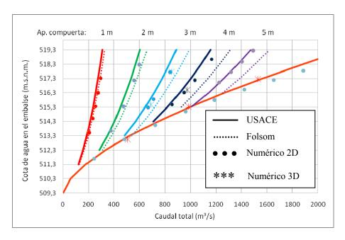
Figura 4 Comparación de los resultados de los cálculos tridimensionales (asteriscos) con los obtenidos de los cálculos bidimensionales y con los de referencia.
