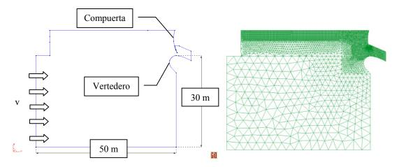
Figura 1 Geometría del modelo (izquierda), y malla de elementos finitos utilizada (derecha).
