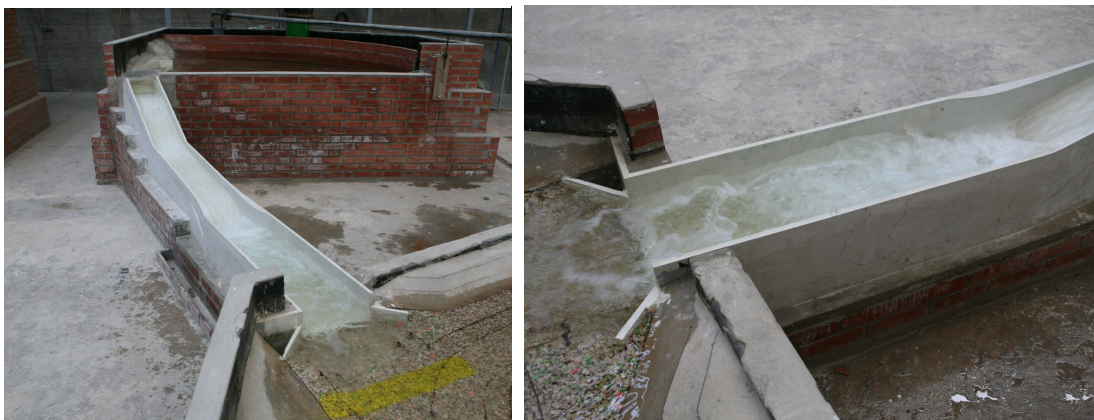
Figura 1. Modelo físico de la presa de Terroba.
