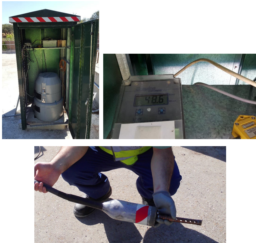
Figura 14 | Instalación para muestrear los flujos en tiempo de lluvia directamente en el colector de Arroyofresno. Se dispone de tomamuestras automático y de limnómetro para activación de la toma de muestras.
