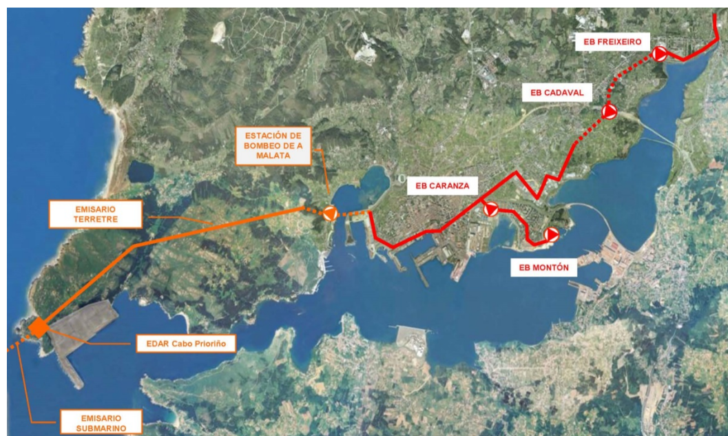
Figura 1 | Esquema general del saneamiento de la margen derecha de la ría de Ferrol tras las primeras obras finalizadas en 2011 (en naranja) y las ejecutadas en la década de los noventa (en rojo)
