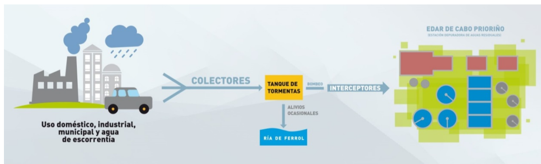
Figura 3 | Configuración formal del sistema de saneamiento adoptado para la actuación de los Interceptores generales de la margen derecha de la ría de Ferrol
