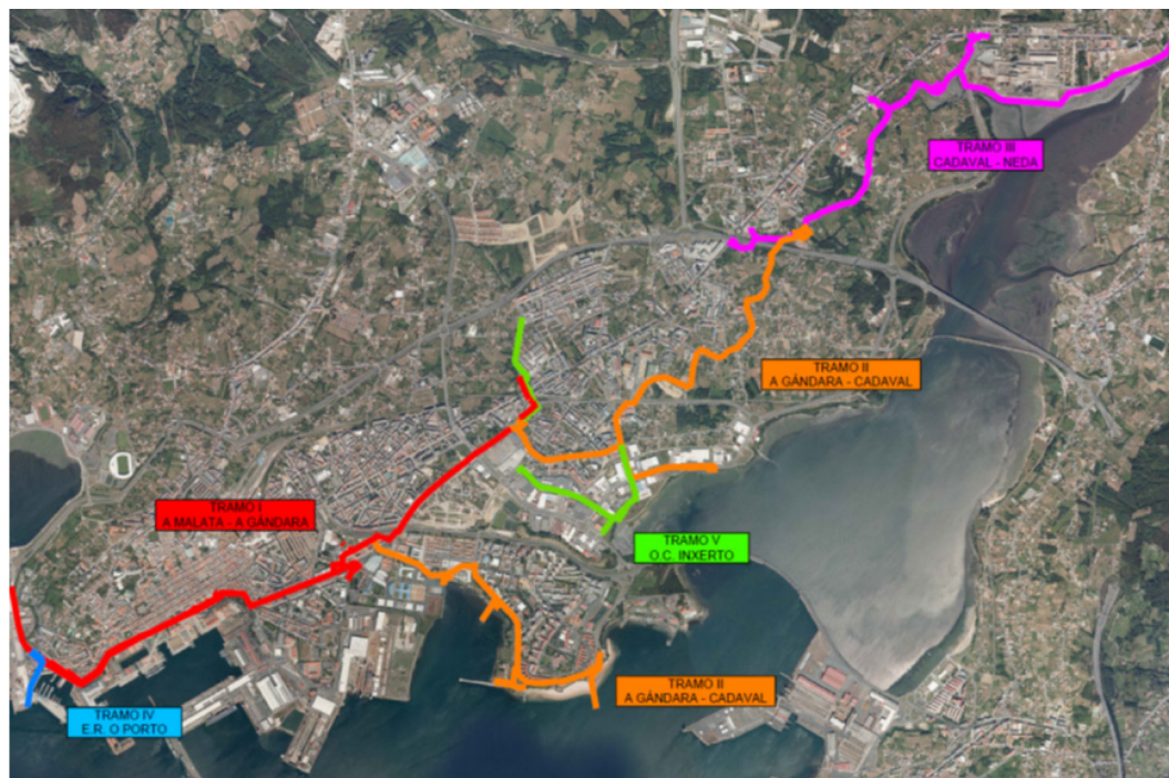
Figura 2 | Esquema general de las obras incluidas en la actuación de los Interceptores generales de la margen derecha dela ría de Ferrol
