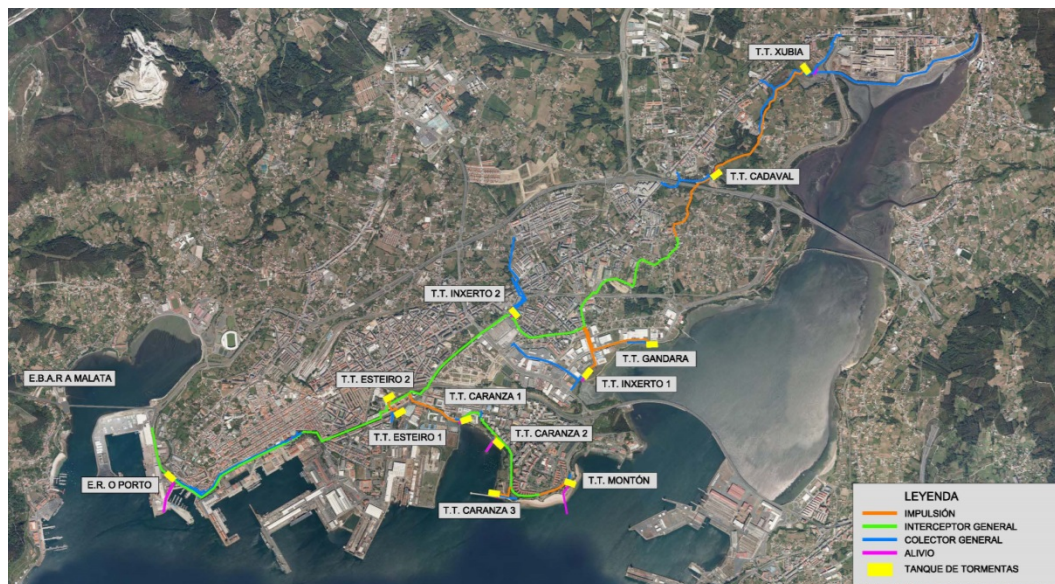
Figura 6 | Esquema funcional de la actuación de los Interceptores generales de la margen derecha de la ría de Ferrol
