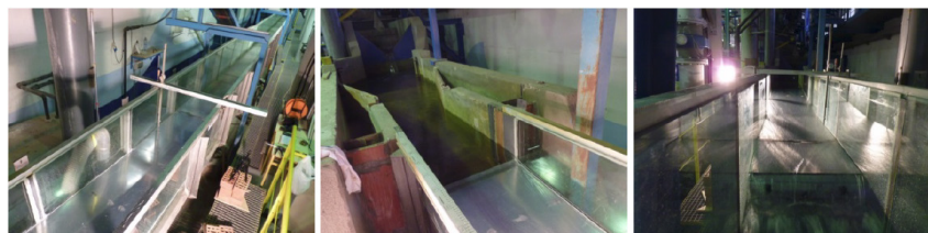
Figura 5 | Modelo de pendiente local variable construido y colocado aguas arriba del canal.
