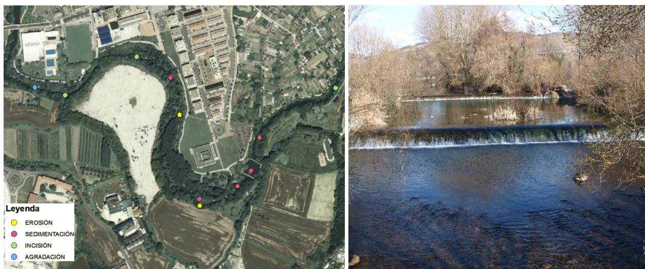
Figura 5 | Procesos geomorfológicos en el cauce en presencia del relleno antrópico (izquierda) y fotografía de los dos azudes que controlan gran parte de la inundación en la zona (derecha).
