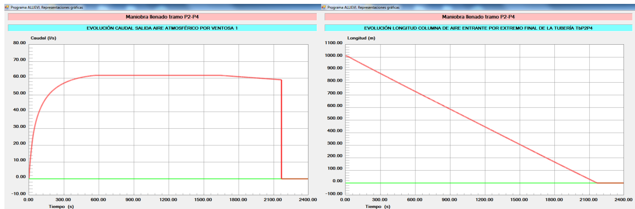
Figura 15 | Llenado de la tubería entre las secciones P2 y P4. Evolución del caudal de aire expulsado por la ventosa (condiciones atmosféricas). Y evolución de la longitud de la columna de aire en el interior de la tubería de ensayo.
