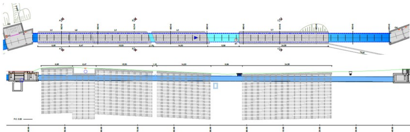
Figura 10 | Planta y alzado del cruce previsto bajo la Avenida Alfonso Molina. Disposición de pantallas de micropilotes y losas.
