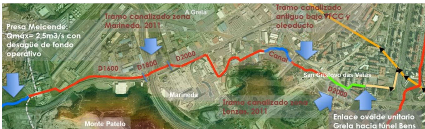
Figura 6 | Trazado canalizado del río de La Grela en la actualidad
