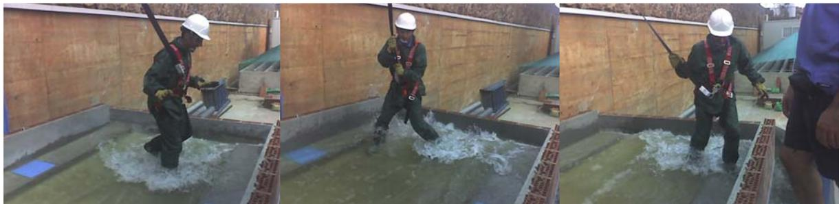
Figura 6 Individuo durante un ensayo con un caudal de circulación de 300 l/s y una pendiente longitudinal del 6%.
