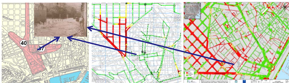
Figura 8 A la izquierda, el área en rosa representa zonas históricamente afectadas por inundaciones. En el medio, una simulación 1D muestra el comportamiento hidráulico de la red para una lluvia con periodo de retorno de 10 años. A la derecha, un mapa de peligrosidad evidencia condiciones de peligrosidad alta. Las flechas indican la posición de la Calle Sant Pau representada en foto durante un evento de lluvia.
