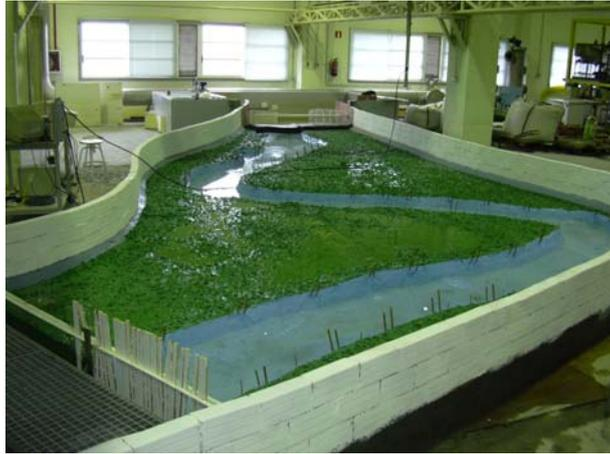
Figura 4 Modelo físico a escala 1:20 del tramo de estudio.
