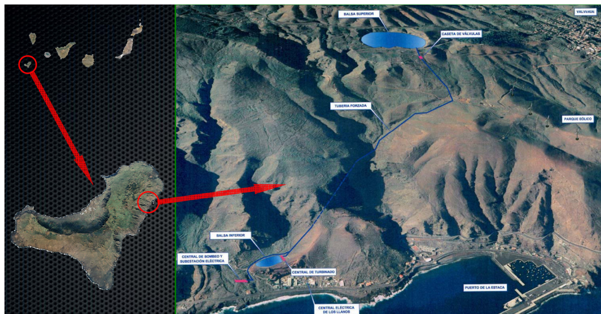
Figura 3. Esquema general de la planta hidroeléctrica proyectada en la isla del Hierro. Tomado de la documentación del proyecto europeo STORIES ( http://www.storiesproject.eu/ )
