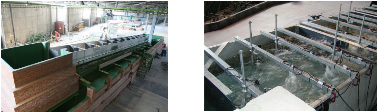
Figura 1 Modelo experimental de la escala de peces (izquierda) y detalle de la red de cámaras instalada en el modelo (derecha).
