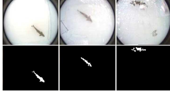
Figura 4 Diferentes imágenes reales obtenidas durante los ensayos y el resultado de su análisis con la red de neuronas artificial. El color blanco indica la detección de un pez.
