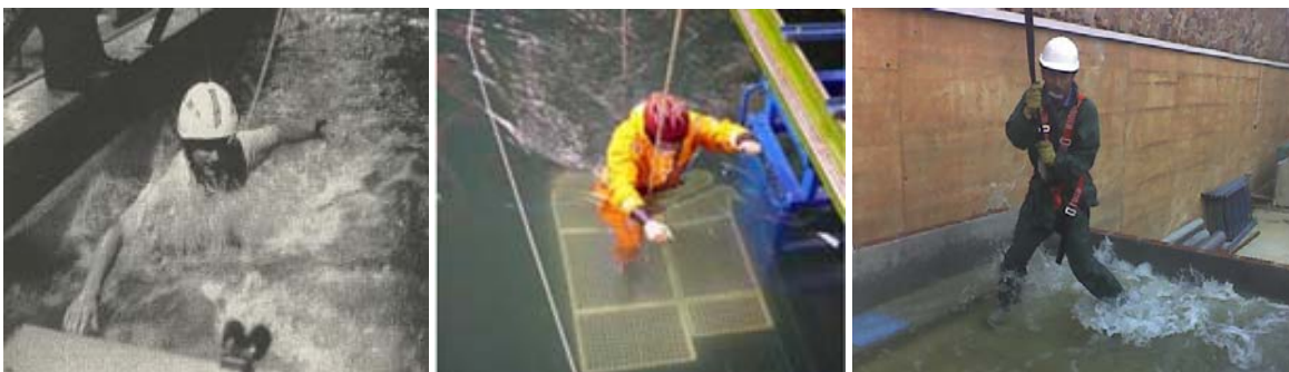
Figura 1 A la izquierda y al centro experiencias experimentales para simular el flujo en llanuras de inundación (Abt et al. , 1989; ARMC, 2000. A la derecha imagen de la campaña experimental en plataforma UPC que simula calle urbana.
