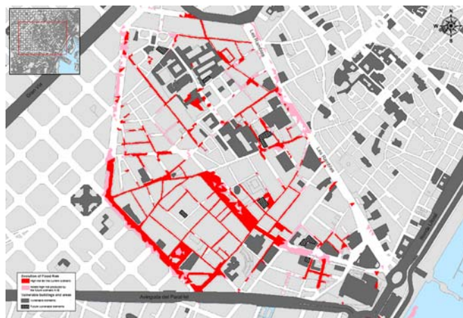
Figura 2 Evolución del riesgo de inundaciones en el Barrio del Raval (Barcelona) por efecto del cambio climático (en rojo se representan las zonas con alto riesgo para el escenario actual, en rosa las zonas que quedarían en condiciones de riesgo alto por efecto del cambio climático).
