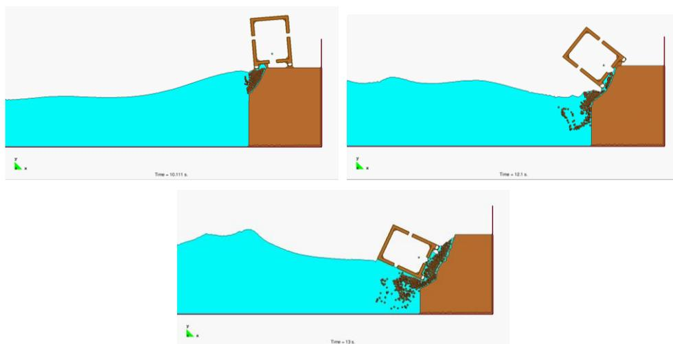
Figura 10 Caída de un camión al mar por erosión de la base granular sobre la que circula debido al oleaje
