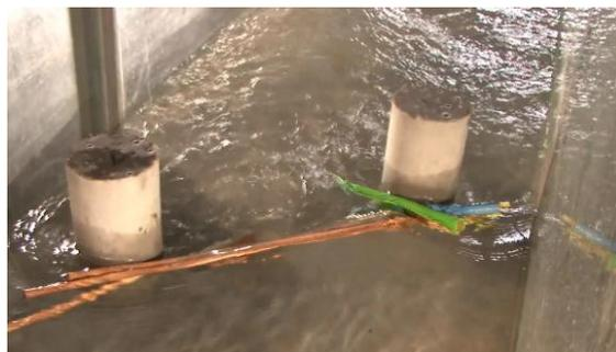
*Figura 15. Atasco de troncos alrededor de un obstáculo en el canal del laboratorio*
