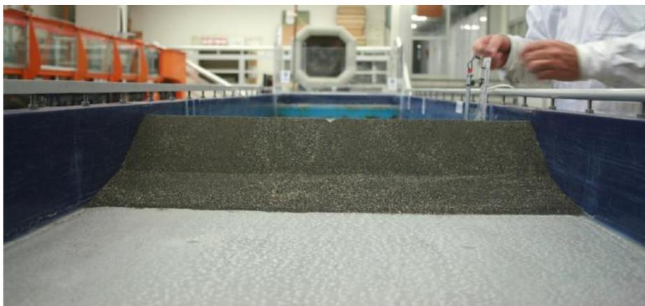
Figura 4. Modelo físico con la presa antes de la rotura
