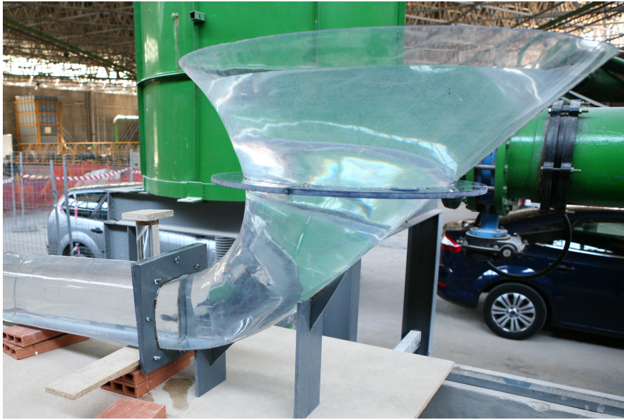
Figura 11 Prueba de estanqueidad
