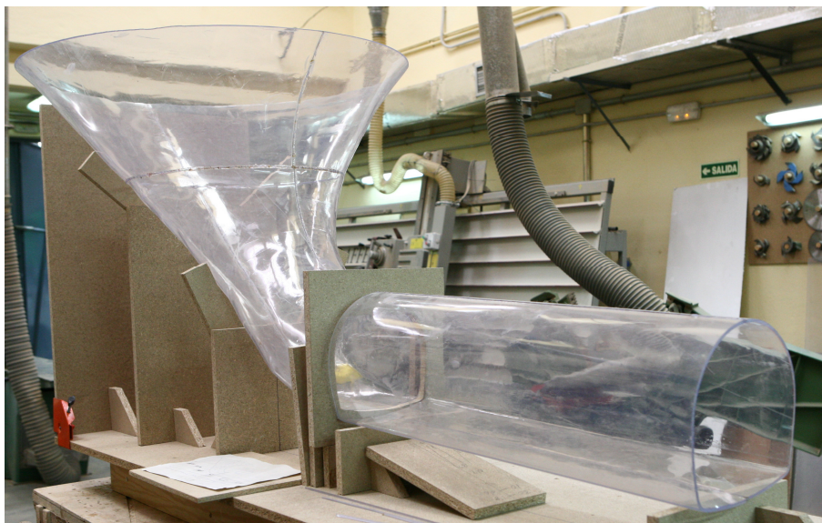
Figura 10 Aspecto final codo soldado en taller
