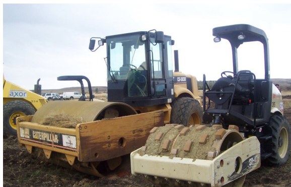
Figura 7 Los rodillos, fundamentales en los trabajos de movimientos de tierra
